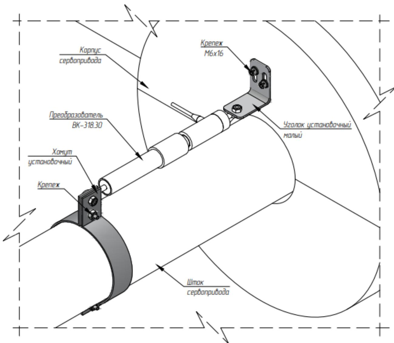
Рисунок 3 – Установка преобразователя-измерителя ВК-318.30 с использованием комплекта монтажного (хомут и уголок малый)
